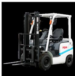
Малозумные производительные погрузчики нового поколения, предназначенные для транспортировки, подъема и опускания грузов до 1,8 тонн, как в помещениях, так и на открытом воздухе.
