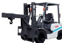
Стрела крана состоит из перевернутого L-образного рычага, прикрепленного к пальцевому брусу, с крюком на конце. Это приспособление используется для грузовых операций с грузами, которые невозможно поместить на поддоны из-за их нестандартной формы или размера, и которые подвешиваются за крюк.
