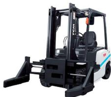
Позволяют безопасно и эффективно выполнять грузовые операции с бетонными блоками, захватывая груз с обеих сторон. Во многих случаях грузовые операции с бетонными блоками, длина каждого ряда которых составляет 39 см, выполняются по два или три ряда одновременно. Поэтому размер рычага для этого применения является заранее определенным.
