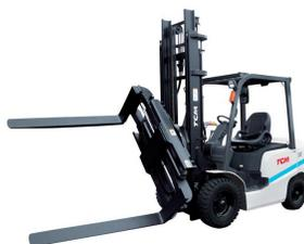
Поворотный вилочный захват представляет собой вилочный захват с поворотным устройством. С этим приспособлением погрузчик, перевозящий груз, ширина которого превышает ширину прохода, может проехать через узкий проход, повернув приспособление.
